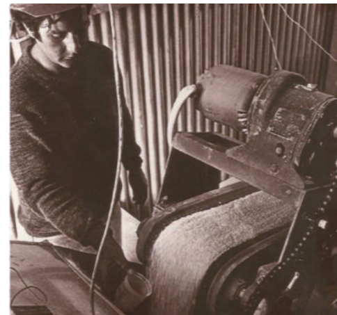
1974年 屋根材表面の石粒用粉砕機
