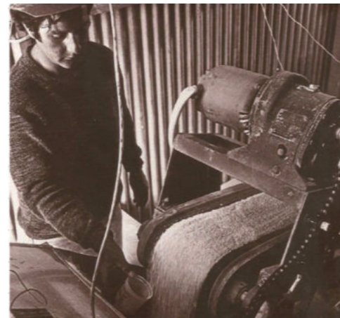
1974年 屋根材表面の石粒用粉砕機
