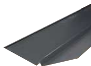
スレートバレー 長さ:1,900mm(有効) 谷収めに使用
